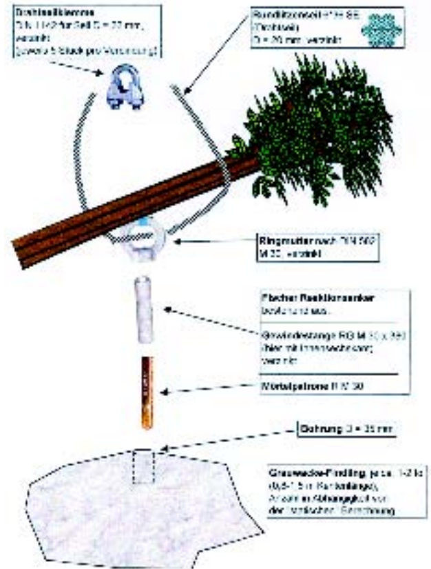
Bild 7: Prinzipische Skizze des Aggerverbandes zur Verankerung der Totholzelemente in der Bröl
