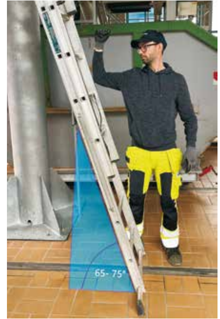
Abb. 2: Anstellwinkel mit Zeichnung (Foto: SOWAG Zittau mbH)
