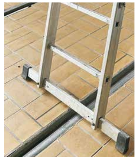
Abb. 3: Fußverbreiterung (Foto: SOWAG Zittau mbH)
