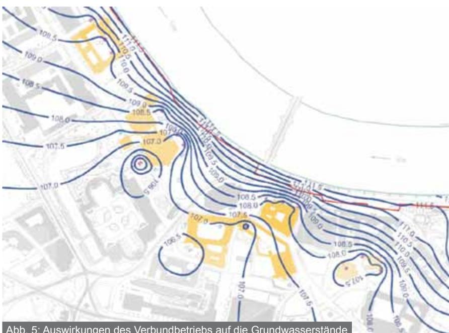
Abb. 5: Auswirkungen des Verbundbetriebs auf die Grundwasserstände
