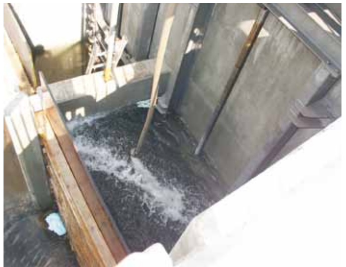
Abb. 10.2: Druckwasserprobe der Schützen
