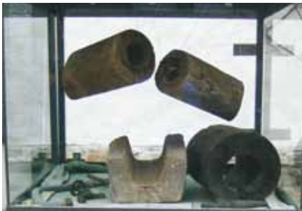
Modellteile einer Holzwasserleitung (Foto: Sven Beyer)
