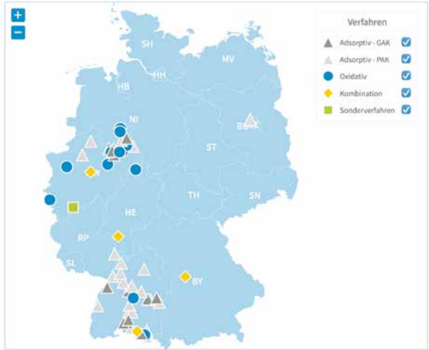
Abb. 7: Interaktive Landkarte zu Kläranlagen mit einer vierten Reinigungsstufe im Betrieb (Quelle: DWA (neue Anlagen können über landkarte@dwa.de gemeldet werden))
