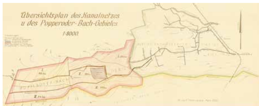
Abb. 6: Abwassertechnisch mögliche und sinnvolle Stadterweiterungsgebiete (Lageplan) Thiem, Leipzig, 1929 (Quelle: aus Archiv ZVA)
