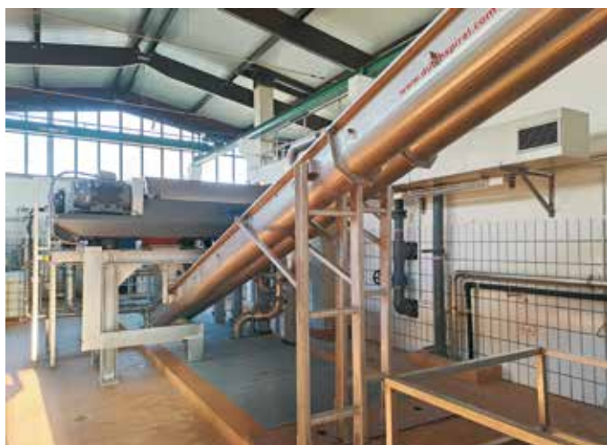
Abb. 5: Spiralförderer für entwässerten Schlamm (Foto: AFRY Deutschland GmbH)
