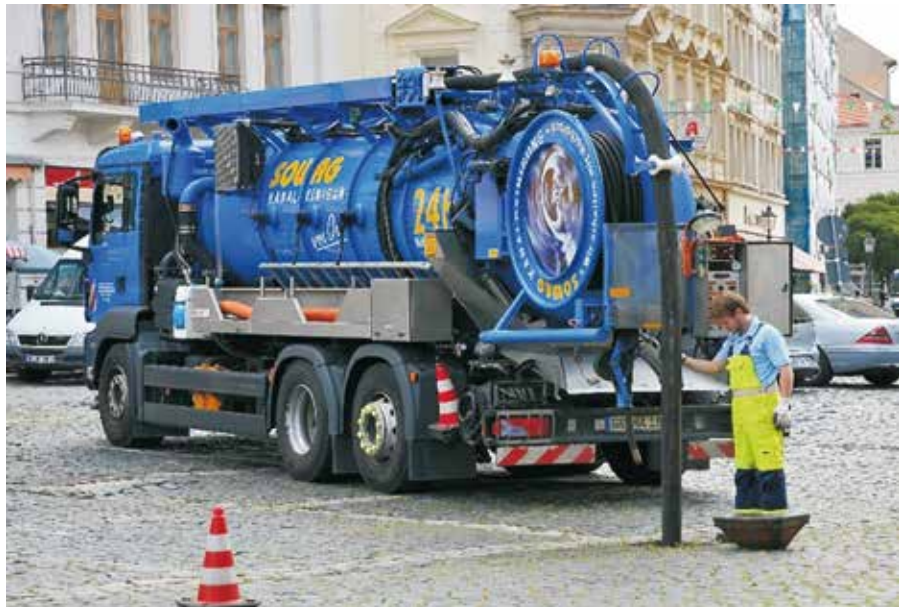
Abb. 2: Hochdruckspüler im Einsatz (Foto: SOWAG mbH)
