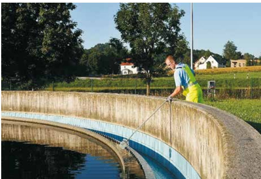
Abb. 1: Probenahme aus dem Nachklärbecken (Foto: SOWAG mbH)
