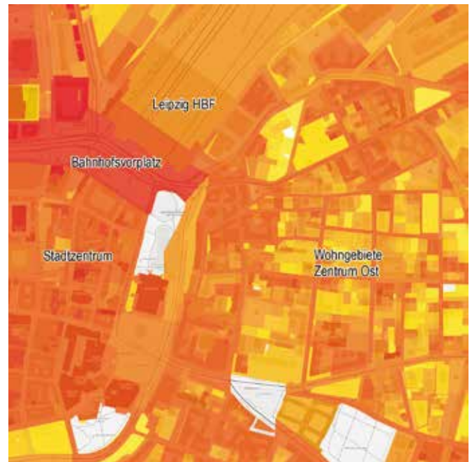
Abb. 4: Erforderliche Verdunstungsspende je m² Flurstücksfläche in Abhängigkeit der naturnahen Wasserbilanz im gesamten Stadtgebiet und im Detail (Quelle: IWS)
