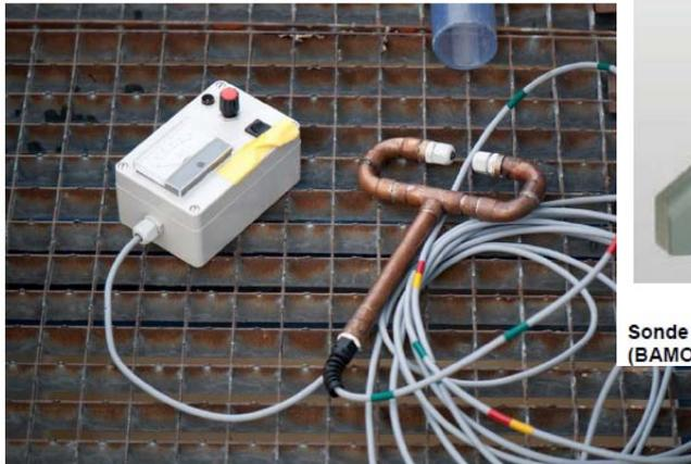
Abbildung 14: Sonde E als Eigenbau mit Hilfe von Kupferrohren, Bedienelement mit Skala und Potentiometer
