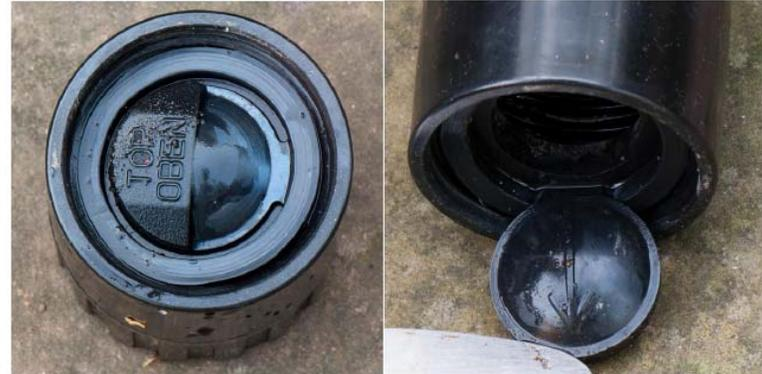
Abbildung 6: Rückschlagventil Messrohr A 5 cm Gum. und B 4 cm Gum. Draufsicht und Seitenansicht mit geöffneter Ventilklappe aus Gummi
