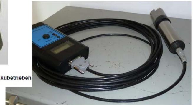
Abbildung 13: Sonde D in Edelstahlgehäuse, abkoppelbar von Bedienelement. Bedienelement mit Digitalanzeige
