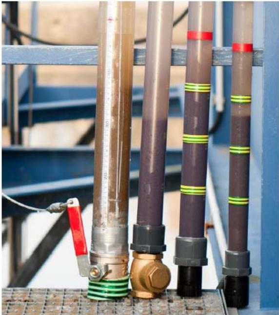
Schlammpegelmessrohre mit unterschiedlichen Durchmessern und Verschlussarten.
