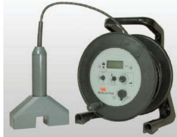
Sonde C mit Kabeltrommel und integriertem Bedienelement, akkubetrieben (BAMO IER 2010)
