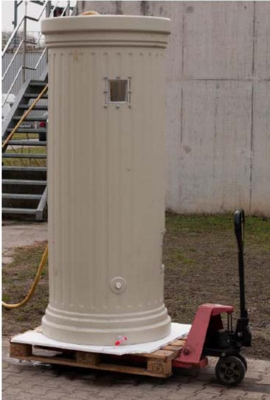
Abbildung 17: Versuchsbehälter auf der Kläranlage Lüneburg beim Befüllen mit Belebtschlamm aus dem Belebungsbecken (Hintergrund)
