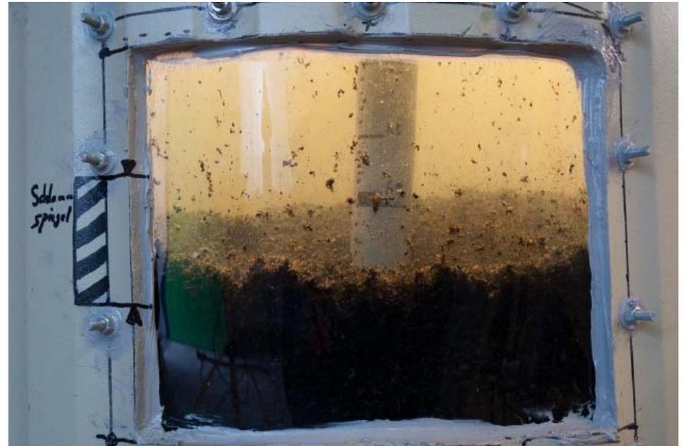
Abbildung 20: Versuchsschlamm im Versuchstank fast vollständig abgesetzt
