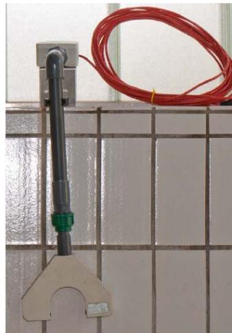
Sonde B Trüb. Stationäres Schlämmpelgemessgerät zum Einbau in eine Kleinkläranlage
